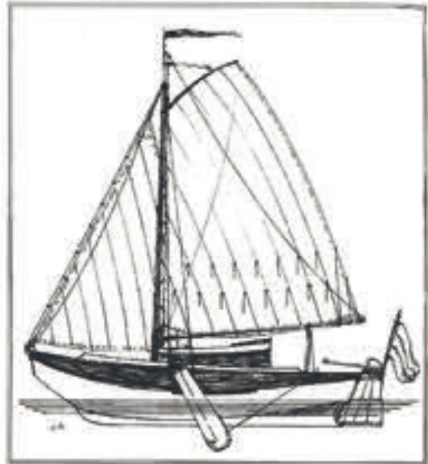
Eine Zalmshouw mit Gaffelrigg, das Großsegel ist ein Gaffelsegel, die Mastenlender nennen es auch den "fallenden Baum". Am Mast ist das Groß mit Mastseils angebracht, das Diesterfeld ist lose und wird nur an Falls und Schothorn befestigt. Die Fock ist eine "Botterfock", die wie eine Genua bis hinter den Mast reicht.
