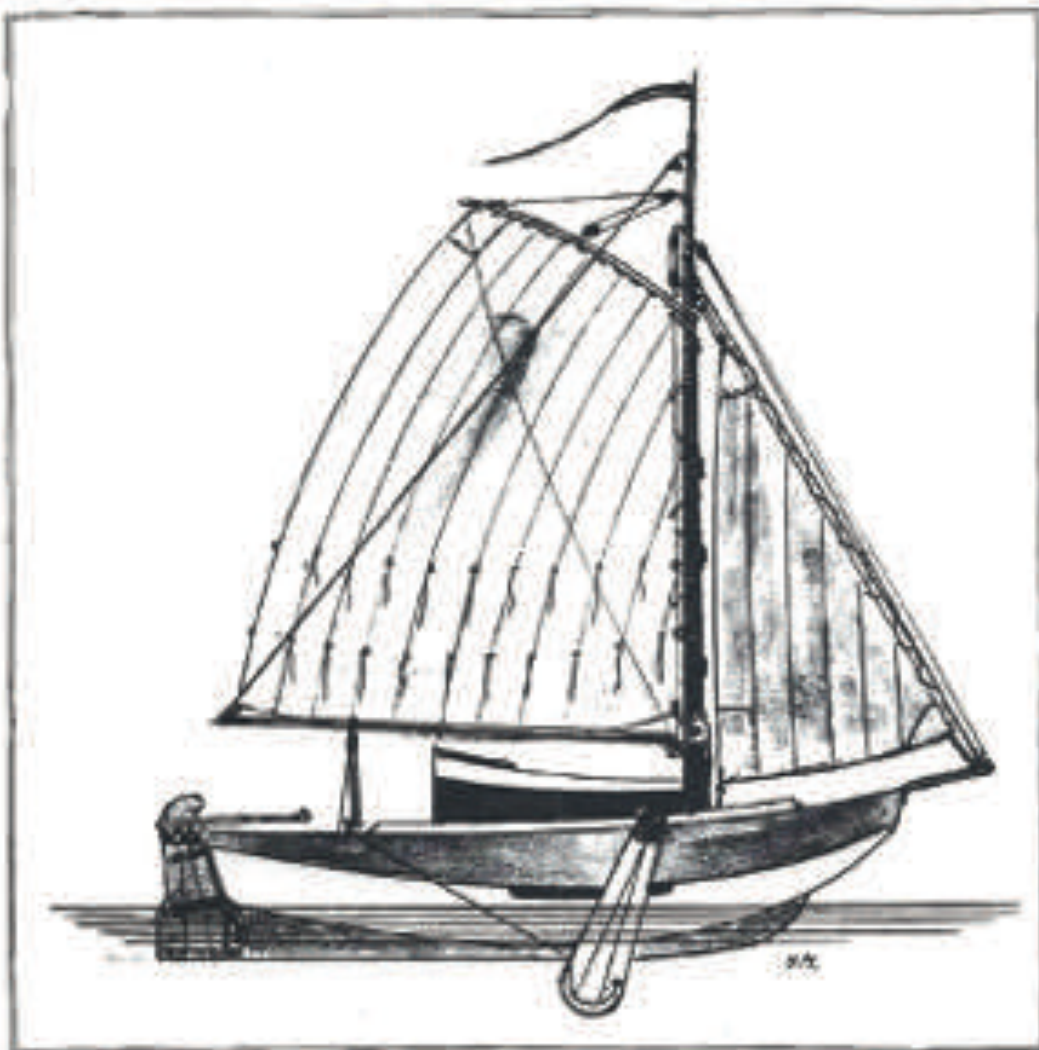
Eine Zeechout mit Fisperrmannschick, die nur bis vor den Mast reicht. Zusätzlich führt sie aber ein "Devoel", einen kleinen, eisernen Bugspriet, an dem das Voortag und der Fockhals befestigt sind.
