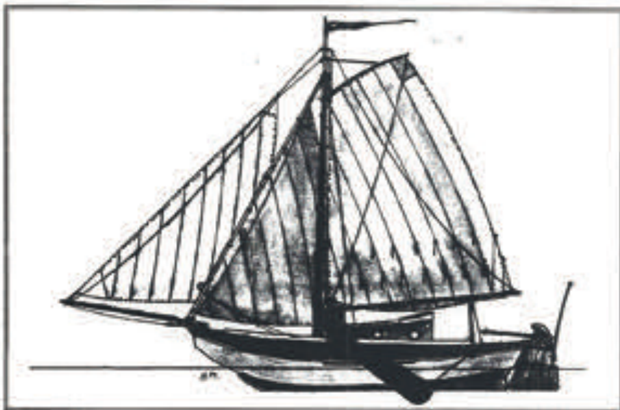
Diese Zalmshouw fährt zusätzlich noch ein Klüversegel an einem Klüverbaum, das eingeholt oder hochgekloppt (geopt) werden kann.
